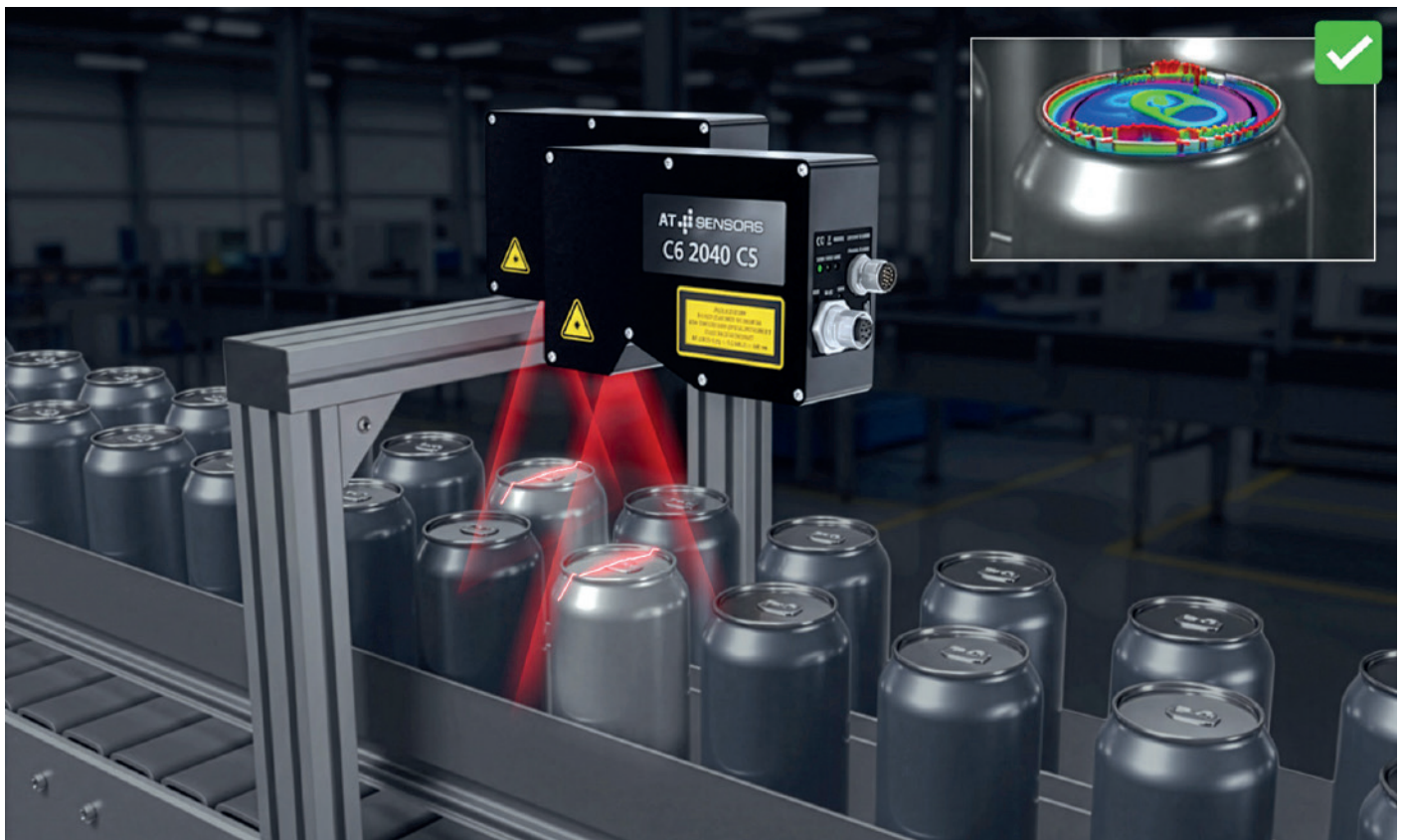
Mithilfe von 3D-Scans werden Getränkedosen auf Füllmenge und -druck mit hoher Geschwindigkeit inspiziert und bewertet.
